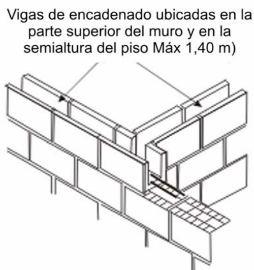
Figura C7.4.3. Barras de vinculación en intersecciones de muros
