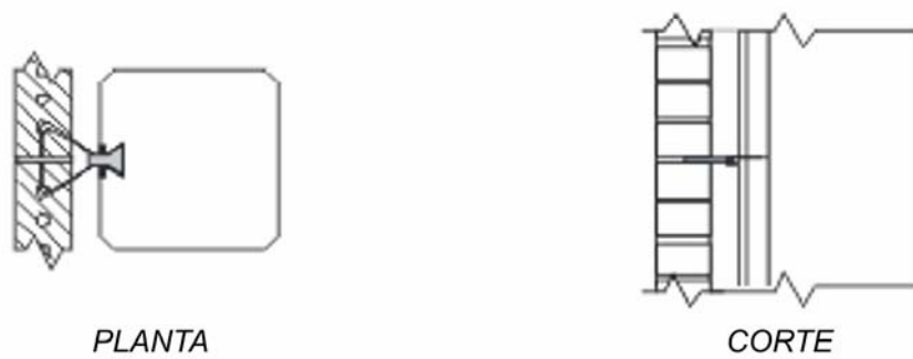
(b) Anclaje a una columna de hormigón
